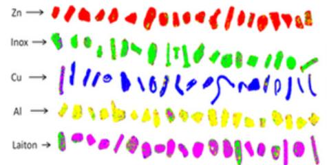
**La bande transporteuse de MULTIPICK tourne en effet à plus de 1 mètre par seconde.** MULTIPICK est capable d'absorber en une seule passe jusqu'à **20 types de matériaux**. En comparaison, les systèmes actuels (notamment l'éjection pneumatique) sont capables de séparer jusqu'à deux familles simultanément...
