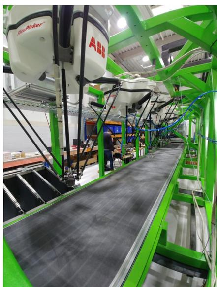
En fonction de l'intégration de nouveaux capteurs, le tri pourrait être étendu à des **déchets plastiques ou métalliques contenant des polluants** (ex : le plomb), les caoutchoucs, etc.
